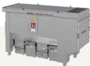
Spänesammeltonnen mit eingelegtem Spänefangsack
