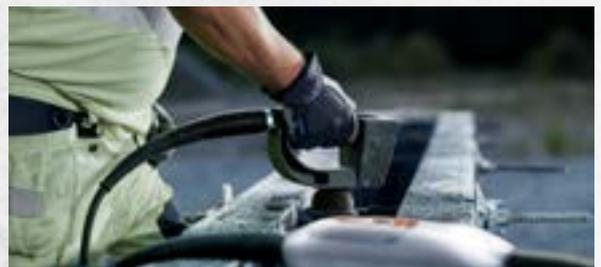
Die Smart-E-Version verfügt über einen Pistolengriff, der die Hand-/Arm-vibrationen verringert.
