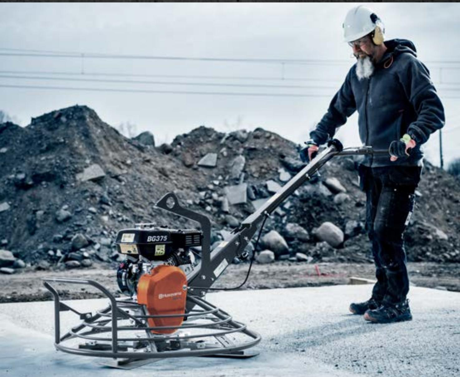
SERIE HUSQVARNA BG | OBERFLÄCHENBEARBEITUNG VON BETONDECKEN/HANDGEFÜHRTE GLÄTTMASCHINEN
