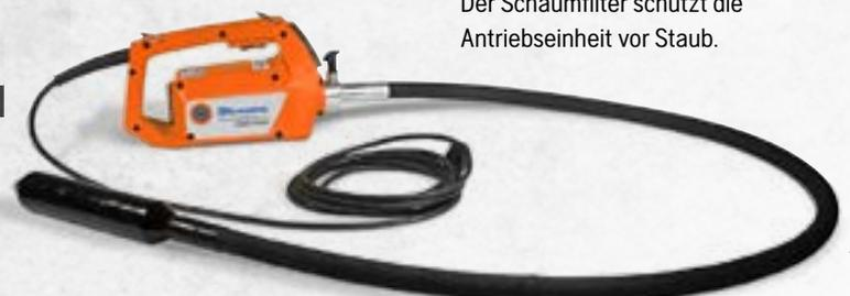
*In unseren mechanischen Rüttlern werden die Vibrationen durch ein sich im Rüttlerkopf drehendes Pendel erzeugt. Eine flexible, rotierende Antriebswelle überträgt die Kraft von der Energiequelle auf mechanischem Weg über den Schlauch an das Pendel. Die Antriebswelle kann mit einem Benzinmotor oder Elektromotor angetrieben werden. Mechanische Rüttler sind robust und zuverlässig, wenn sie vorschriftsmässig gewartet werden.*
