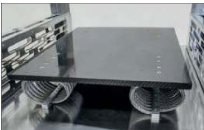
Aufnahmetisch, schwingend gelagert mit Gummipuffer oder Drahtseildämpfer
