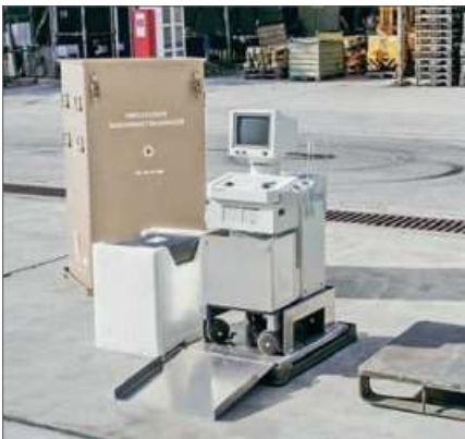
Unterteil mit Auffahrrampe
