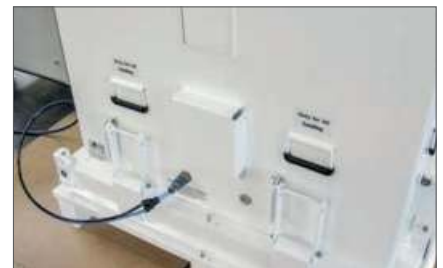
Wasserdampfdichter Behälter bei Dichtheitsprüfung durch Überdruck
