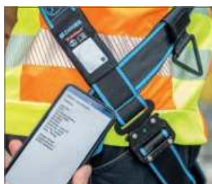
Mit ZmartCheck (NFC-Tag) ausgerüstet.
