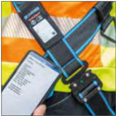
Mit ZmartCheck (NFC-Tag) ausgerüstet.
