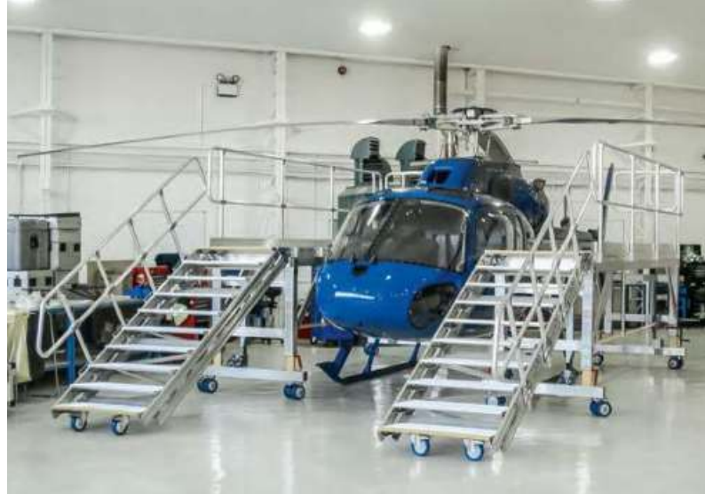
Höhenverstellbare Wartungsbühne für H125
