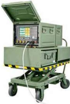
Prüfequipment für Militärflugzeug-Hydrauliksystem
