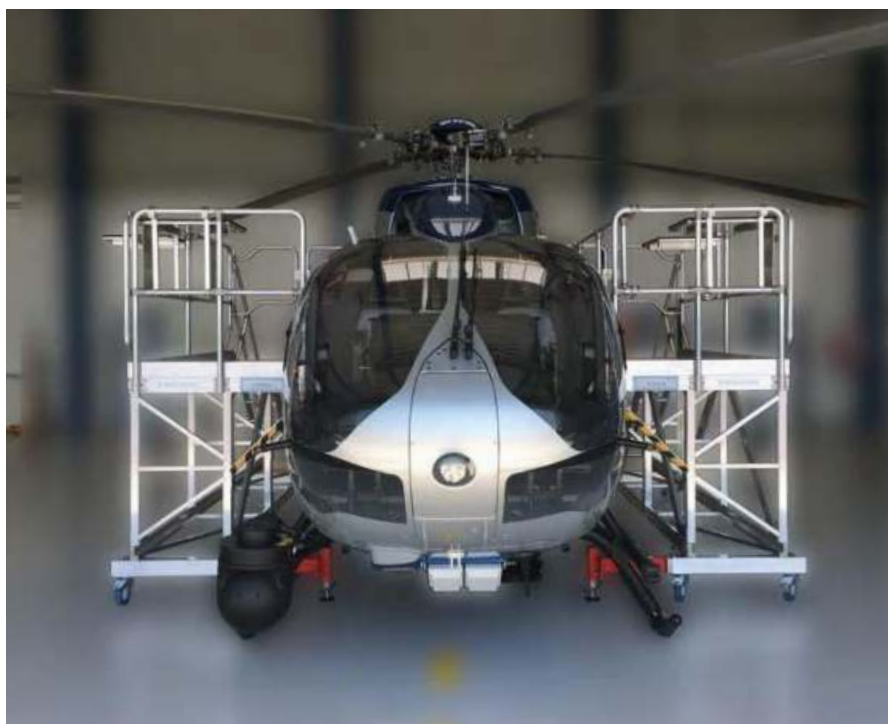
Die Polsterung schützt die Außenhaut vor Beschädigungen
