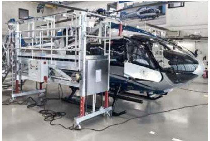
Elektrisch höhenverstellbare und fahrbare Wartungsplattform für den Polizeihubschrauber H145
