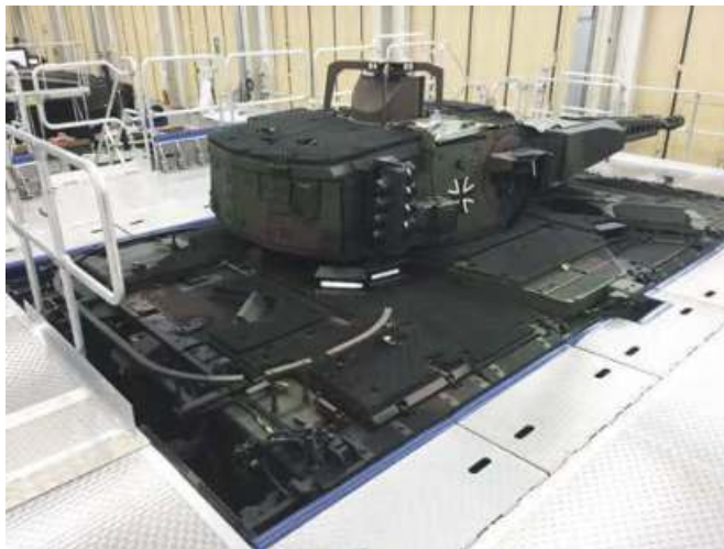
Die modulare Bauweise ermöglicht die abschnittsweise oder vollständige Einrüstung der Fahrzeuge zur Instandhaltungs- oder Trainingszwecken.
