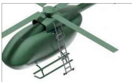
Anlegeleiter für den einfachen und sicheren Zugang zum Rumpfbereich
