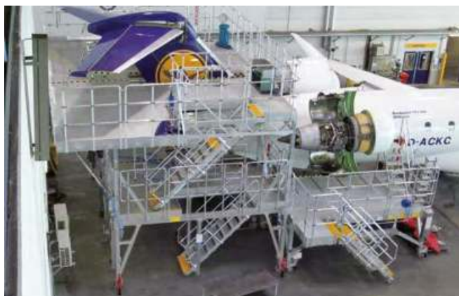
Höhenverstellbares Tail- und Engine-Dock für Bombardier CRJ900
