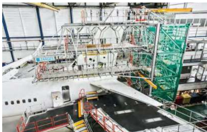
Höhenverstellbares Tail-Dock für die B737- und A320-Familie, mit Kran und Medienversorgung
