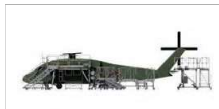
Diese beiden höhenverstellbaren Arbeitsbühnen mit Konturanpassungen ermöglichen optimale Wartungsarbeiten am Black Hawk
