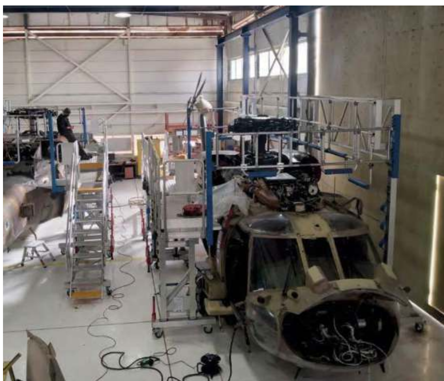
Konturanpassungen gewähren mehr Sicherheit im Zugangsbereich zur Maschine
