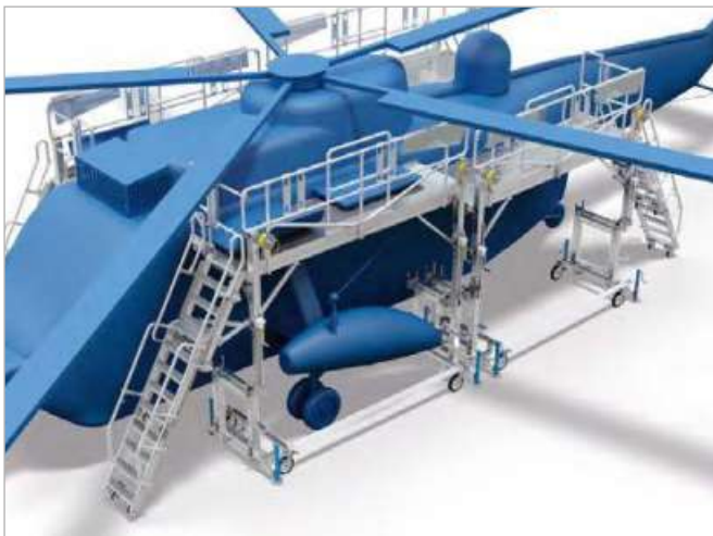
Höhenverstellbare Wartungsbühnen für SeaKing Mk41
