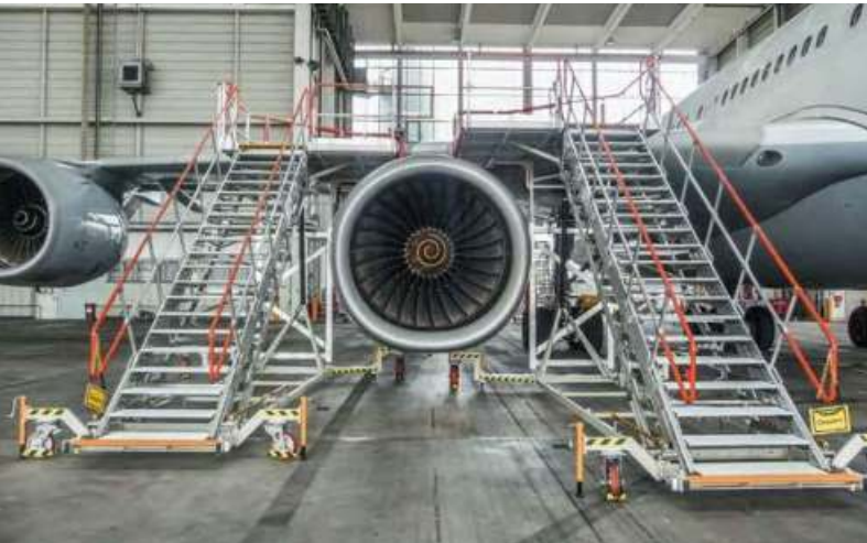
Höhenverstellbares Arbeitsbühnenset am Pylon-Bereich
