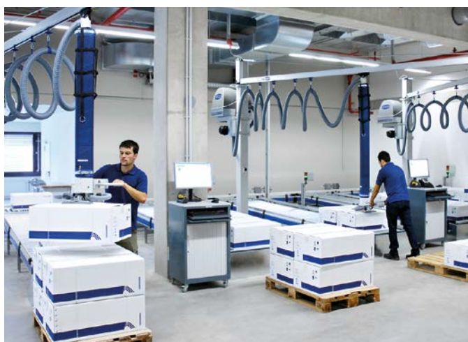
Vakuum-Schlauchheber JumboErgo zum Kommissionieren von Paketen
