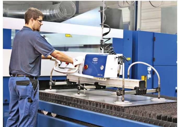
Vakuum-Hebegerät VacuMaster Comfort zum Be- und Entladen einer Laserschneidanlage
