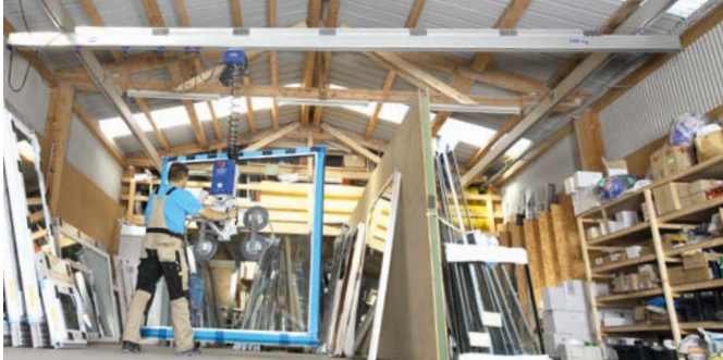
Aluminium-Krananlage SRA mit Kettenzug und Hebegerät VacuMaster
