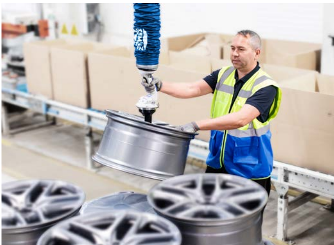
Vakuum-Schlauchheber JumboFlex mit Felgengreifer zur Handhabung von Felgen und Komplettträdern
