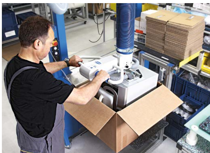
Vakuum-Schlauchheber JumboErgo zum Verpacken von Waren und zur Handhabung der Endverpackung
