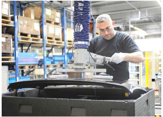
Vakuum-Schlauchheber JumboErgo zur Handhabung von Karosseriebauteilen
