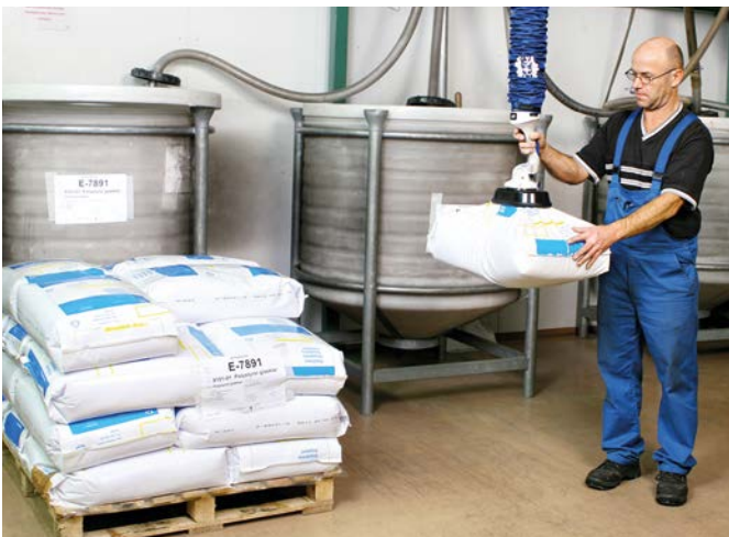
Vakuum-Schlauchheber JumboFlex zur Palettierung von Kunststoffsäcken
