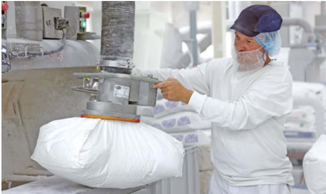
JumboSprint EX zur Handhabung von Säcken im Ex-Schutz-Bereich
