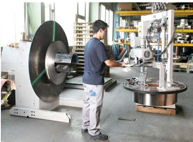
Vakuum-Hebegerät VacuMaster Coil, 90° schwenkbar, zur Handhabung von Coils
