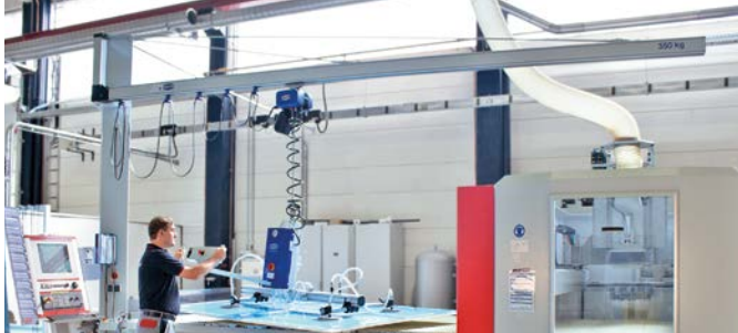
Säulenschwenkkran SK mit Kettenzug und Vakuum-Hebegerät VacuMaster
