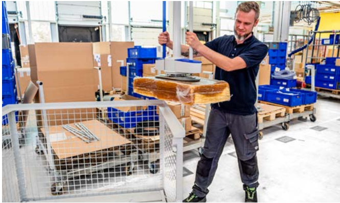
Jumbo Low-Stack beim Umschlag von Rohgummiballen in Gitterboxen
