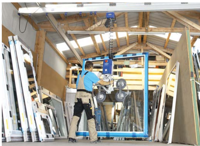
Vakuum-Hebegerät VacuMaster Window Comfort zur Handhabung von Fenstern, Glasscheiben und Glasbauteilen
