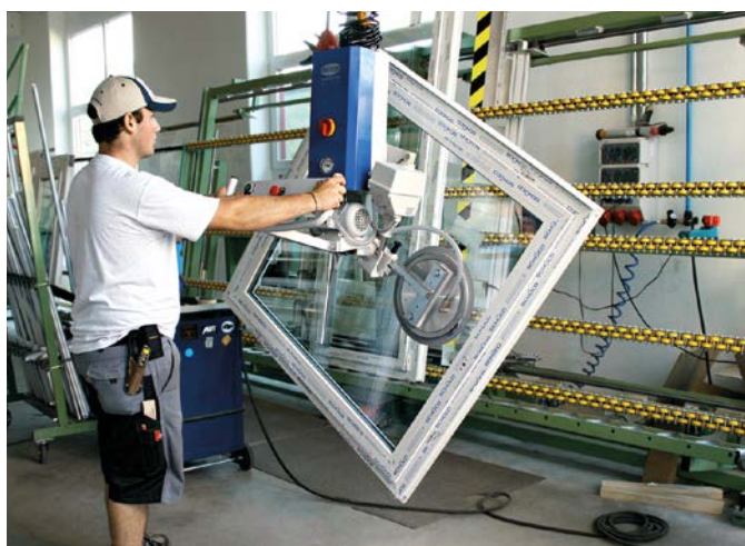
Vakuum-Hebegerät VacuMaster Window Comfort zum Be- und Entladen einer Verglasungspresse
