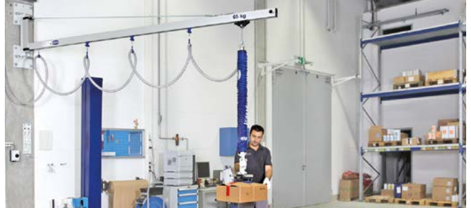
Wandschwenkkran WK mit Vakuum-Schlauchheber Jumbo
