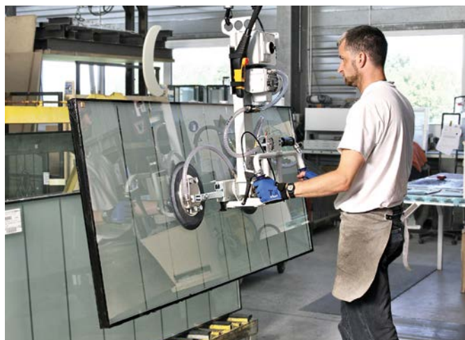
Vakuum-Hebegerät VacuMaster Window zur vertikalen Handhabung von Glaselementen
