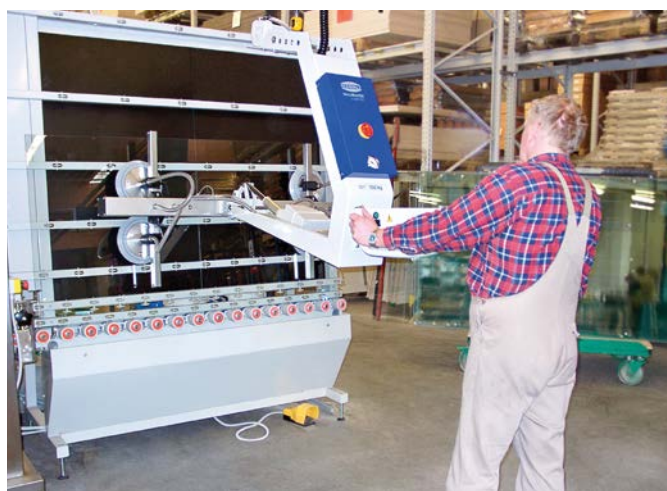
Vakuum-Hebegerät VacuMaster Comfort zum Wenden einer Glasscheibe um 180°
