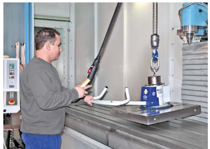
Vakuum-Hebegerät VacuMaster Eco zur energieunabhängigen Handhabung von Metallteilen
