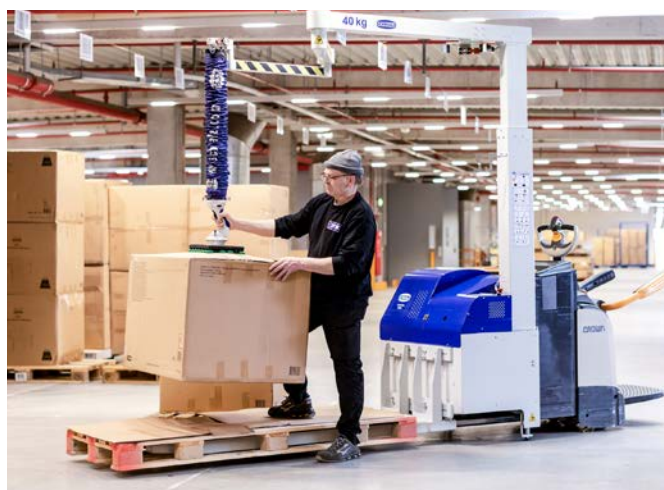
Vakuum-Schlauchheber JumboFlex Picker für die mobile Kommissionierung von Packstücken mit jedem gängigen Flurförderfahrzeug
