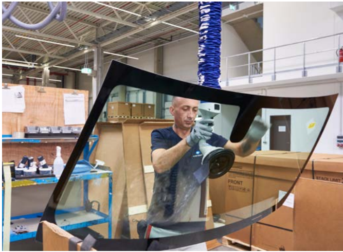
Vakuum-Schlauchheber JumboFlex zur Handhabung von Windschutzscheiben
