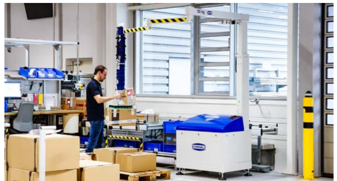
Transportable Schlauchheberlösung JumboFlex Mobile für den Einsatz an wechselnden Orten
