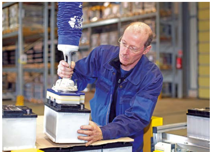
Vakuum-Schlauchheber JumboFlex Battery zur Handhabung von Batterien
