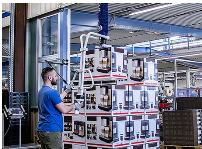
Vakuum-Schlauchheber JumboFlex High-Stack zur sicheren Handhabung diverser Werkstücke bis zu 255 cm Stapelhöhe
