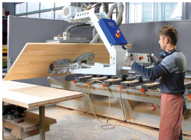
Vakuumschlauchheber VacuMaster Comfort zum Wenden von beschichteten Holzplatten um 180°
