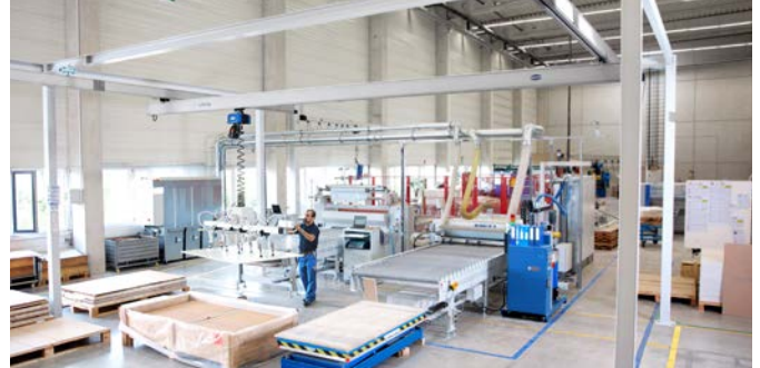
Aluminium-Krananlage SRA mit Kettenzug und Hebegerät VacuMaster
