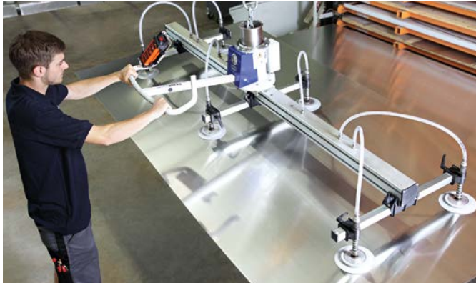
VacuMaster Eco zur Entnahme von Stahlblechen aus einem Regalsystem
