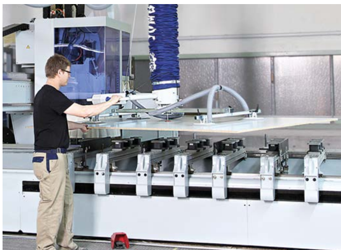
Vakuumschlauchheber JumboErgo zum Be- und Entladen eines CNC-Bearbeitungszentrums
