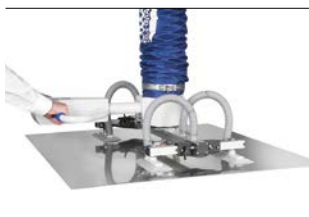
Vierfachsauggreifer Für große Kartons, Platten und biegeschlaiffe Teile. Die Sauger sind längs und quer stufenlos verstellbar.
