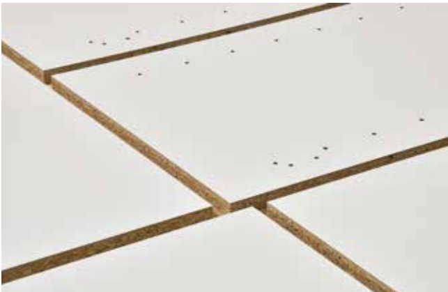
Optimaler Halt des Werkstücks mit dem Hochleistungsvakuum bis zu 1000 m 3 /h.
