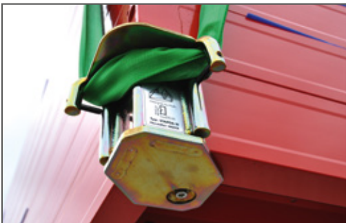
Abb. 12: Detailansicht: Eingebautes Transportgehänge am Elementstapel
