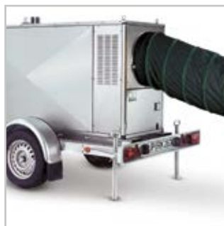
Heizzentrale mit Anhänger, zugelassen für den Straßenbetrieb
