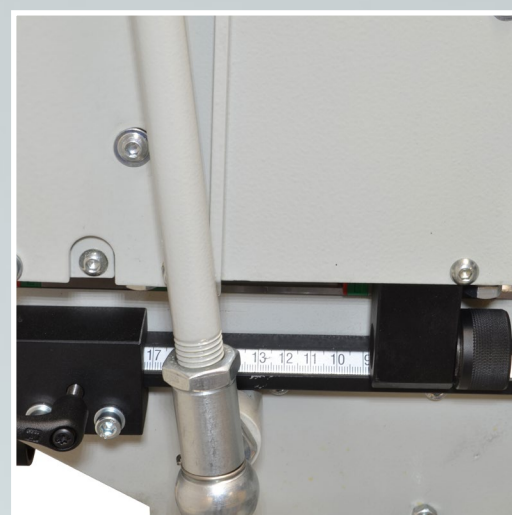
Bohrtiefeneinstellung, Feineinstellung inklusiv
