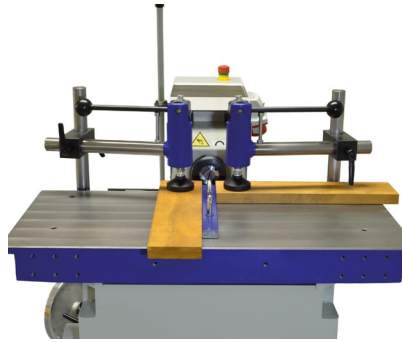
Rahmendübelanschlag 3-fach umsteckbar
