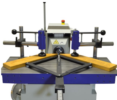
Doppelwinkelverstellanschlag für Winkel von 22,5° bis 75°
