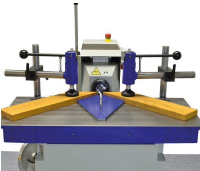
Gehrungsanschlag für Winkel 22,5° und 45°
