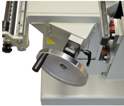
Höhenverstellung nach digitaler Anzeige auf 1 / 10 mm genau
