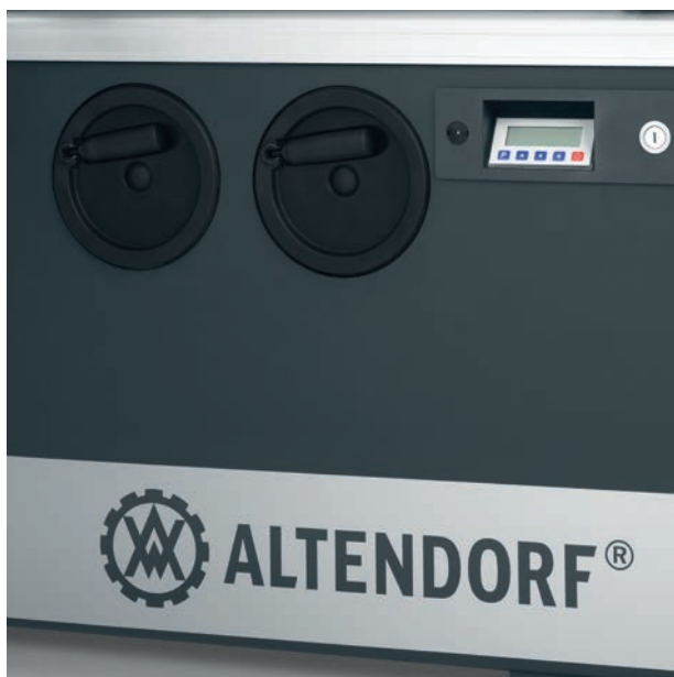
Die Höhen- und Schwenkverstellung erfolgt einfach über zwei ausklappbare Handkurbeln.
